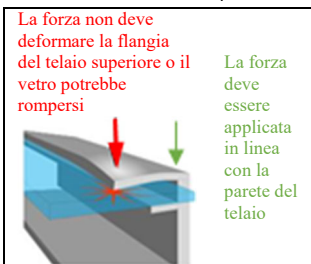
Fig. 1a: posizioni dei morsetti di serraggio
