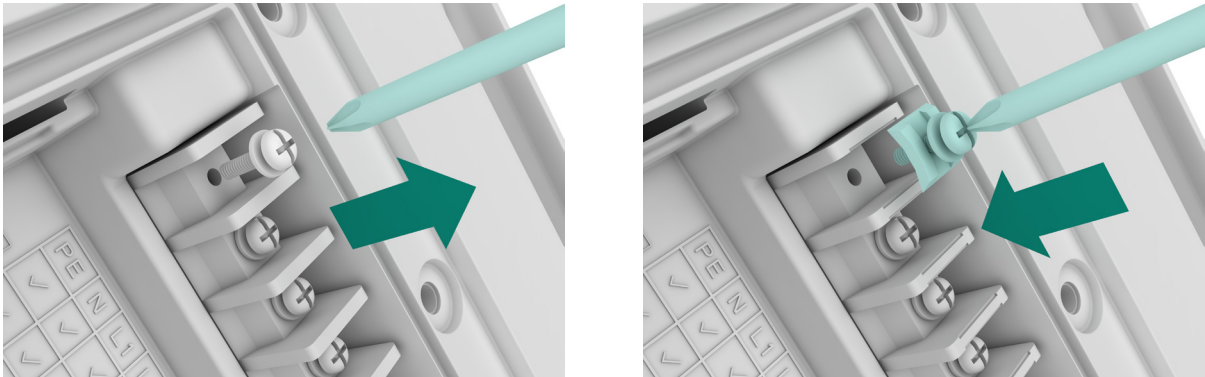
Abb. 9 Einbau der Schraubenplatte
