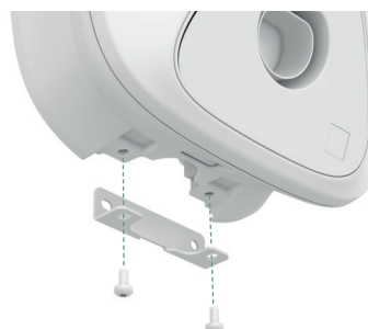
Abb. 17 Befestigen der Unterseite der Ladestation
