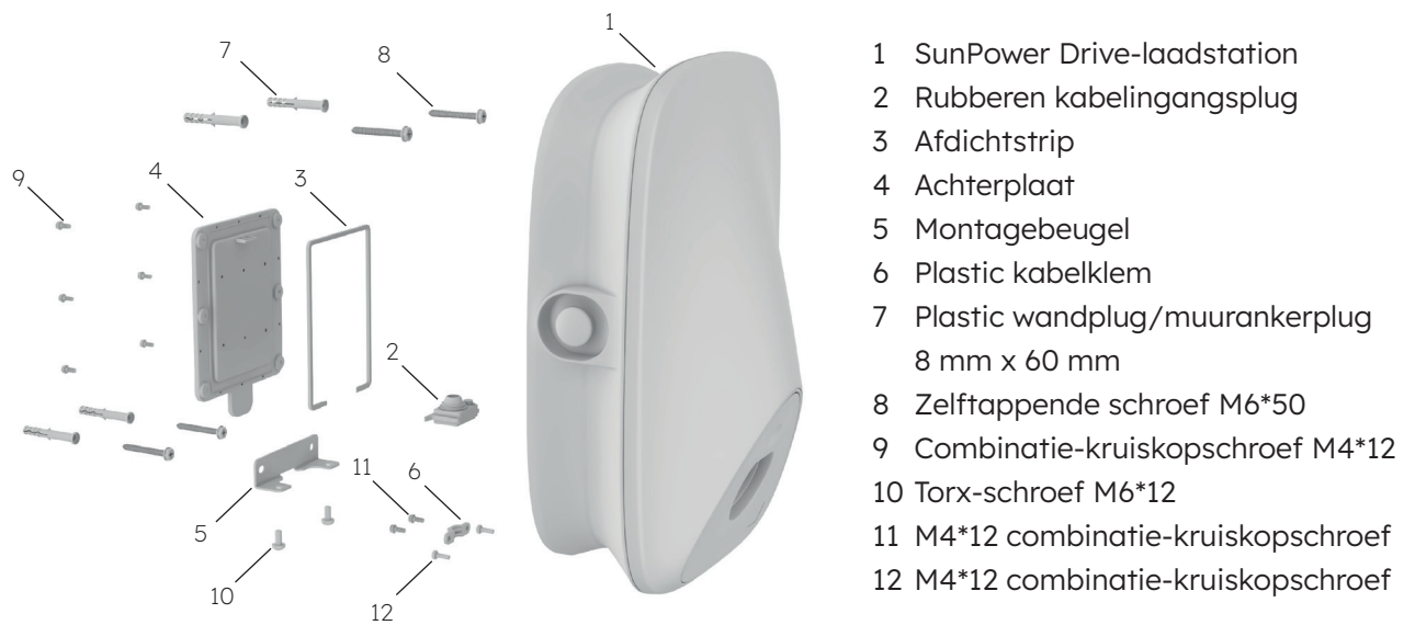
Afbeelding 2 Algemene assemblagetekening van wandmontage
