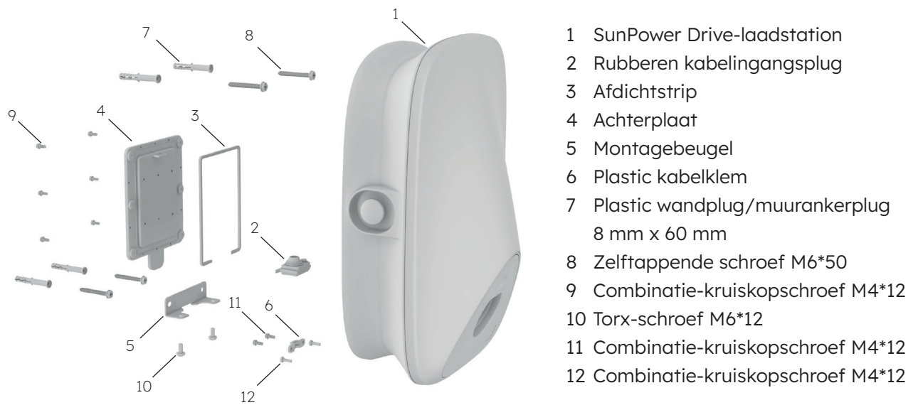
Afbeelding 2 Algemene assemblagetekening van wandmontage
