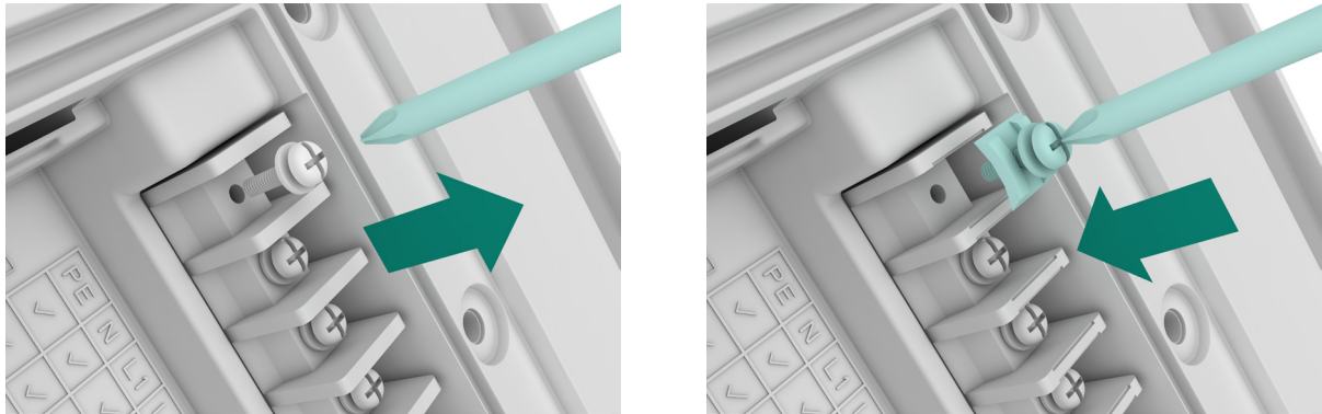
Figura 9 Instalación de la abrazadera del tornillo
