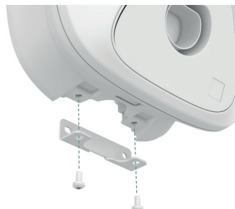
Figure 17. Fixation du bas de la station de recharge
