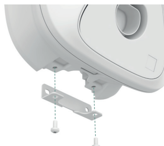
Figura 17 Fijado de la parte inferior de la estación de carga
